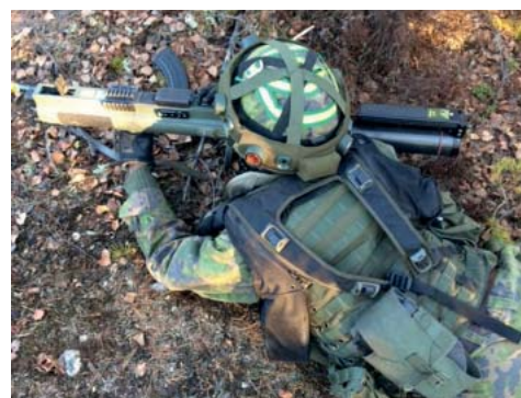
Päivitetyn KASI-järjestelmän uusi pika-kiinnitettävä liivi- ja langaton kypäräosa, sekä 66KES12 simulaattorisisko.
