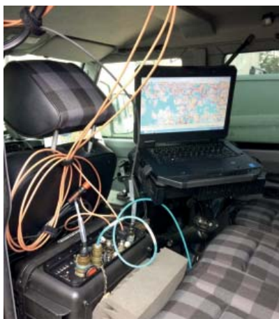
KASI MANPACK300 palautejärjestelmä kiinnitettynä ajoneuvoon. Ajoneuvolla palaute vietään suoraan joukon luokse.
