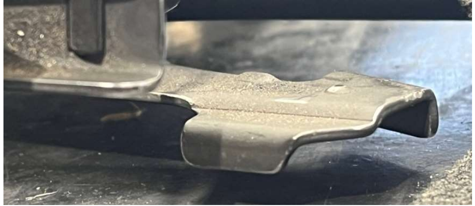
Vaihtimen asentolukituksen nasta
