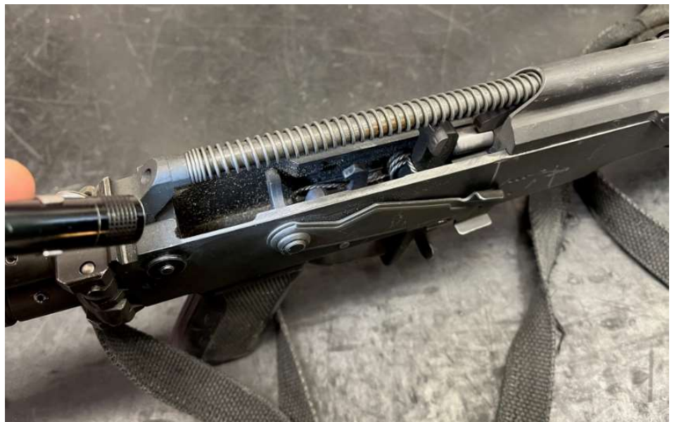
Palauttimessa vähäistä ruostetta
