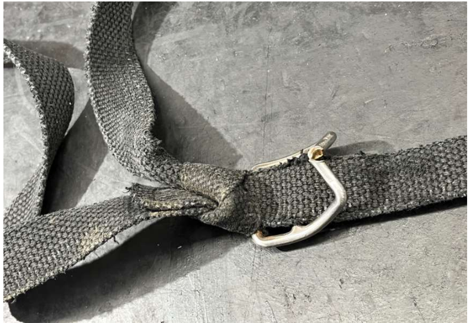
Hihnan solmu ja vaurioitunut lenkki
