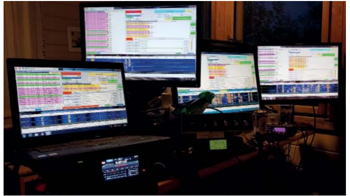
Kuvassa 4 kpl digitaalisia HF-radioamatööri- asemia. Kaikissa tietokoneissa on käytössä uudehko - valtavan suosion maailmalla saavut- tanut lähetelaji -FT8.
